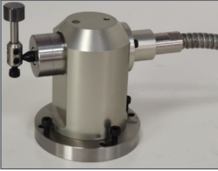
S5TS temaslı takım ayar cihazı. Ölçüm, gövdenin yanındaki silindirik temas yüzeyi üzerinden alınır.
