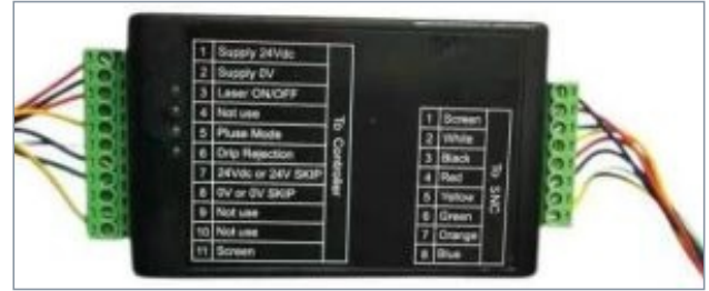
Ara birim ve klemens bağlantıları.
