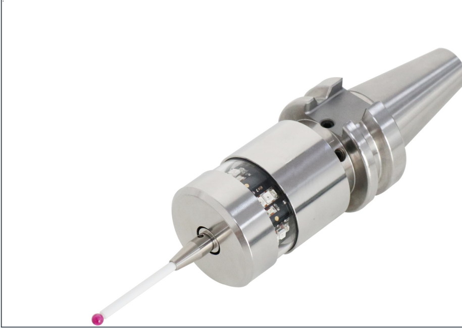
CNC Probing kızılötesi ölçüm probu. İş mili konisine takılır; iletim prob eksen boyu 360 derecedir.
