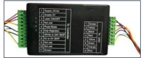
Ara birim ve klemens bağlantıları.
