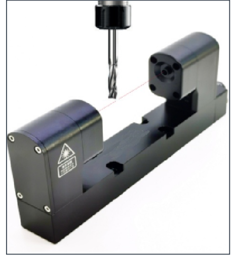
Lazer ışını takım üzerine düşürülür; ışın kesildiğinde sistem tetiklenir.
