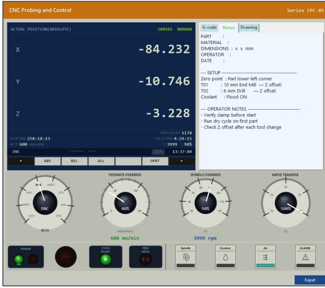
CNC Control izleme ekranı. Eksen konumları, çalışma ve çevrim süresi, parça sayısı, besleme ve devir oranları, çalışan Gcode (Takım Yolu), kurulum bilgileri ve operatör notları tek ekranda.
