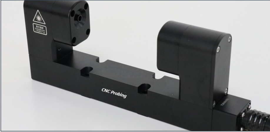
CNC Probing temassız lazer takım ayar sistemi. Verici ve alıcı karşı karşıya konumlanır; takım ışın hattına girdiğinde sistem tetikleme sinyali üretir.
