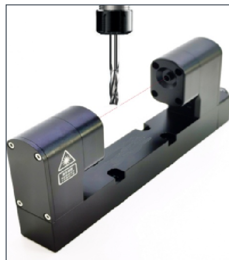
Луч падает на инструмент; при прерывании луча система срабатывает.
