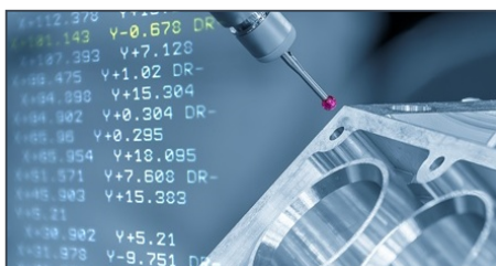
Измерение внутри станка, деталь закреплена.
