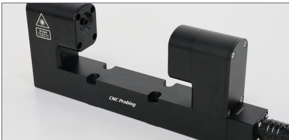
Бесконтактный лазерный датчик привязки CNC Probing. Излучатель и приёмник стоят друг напротив друга; при входе инструмента в луч система срабатывает.
