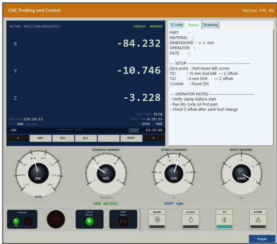
Экран CNC Control. Положения осей, время работы и цикла, число деталей, коррекции подачи и оборотов, текущий G-код, данные наладки и примечания оператора на одном экране.
